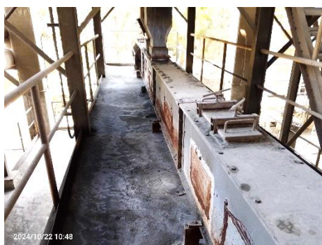
รูปที่ 2-28 ระบบสายพานแบบปิดเพื่อลำเลียงฝุ่นจาก P/H Boiler กลับเข้าสู่กระบวนการผลิต
