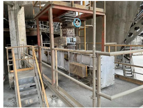
รูปที่ 2-5 ระบบสายพานแบบปิดลำเลียงฝุ่นจาก Dust Precipitation กลับเข้าสู่กระบวนการผลิต
